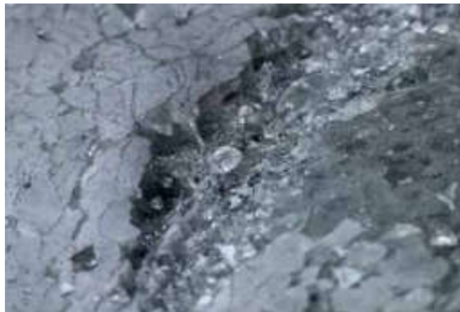
Abbildung zeigt Glasverbund mit GUS Plex nach Sprengversuch
