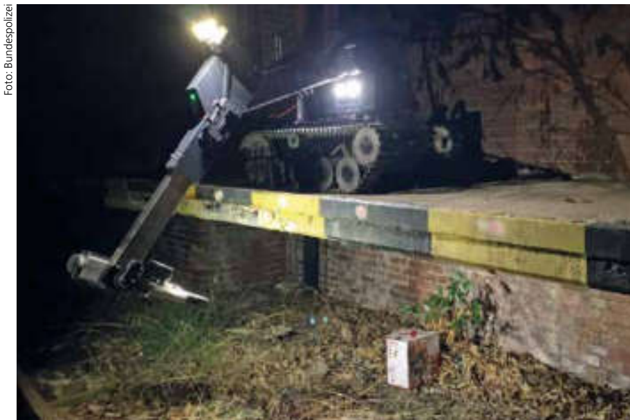
Der Fernlenkmanipulator als technisches Hilfsmittel der Entschärfer auf einem Bahnsteig in der Dunkelheit
